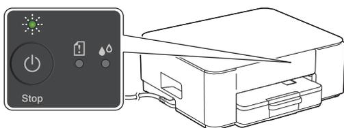
El equipo se encenderá automáticamente y el LED de encendido comenzará a parpadear.
