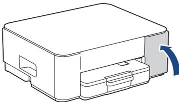
Cuando haya instalado los cuatro cartuchos de tinta, cierre la cubierta del cartucho de tinta. El equipo comenzará el proceso de limpieza inicial del sistema de tinta.
