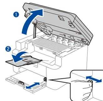
Passen Sie die Papierführungen an, sodass sie dem verwendeten Papier entsprechen.
