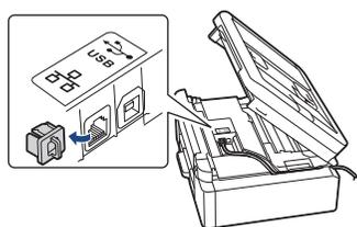
Pour établir une connexion USB ou une connexion au réseau câblé (certains modèles seulement) repérez le port correct (en fonction du câble utilisé) à l'intérieur de l'appareil, comme indiqué sur l'illustration.
