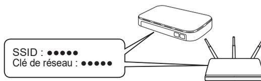
Recherchez le SSID (nom du réseau) ainsi que la clé de réseau (mot de passe) sur votre point d'accès/routeur sans fil.
