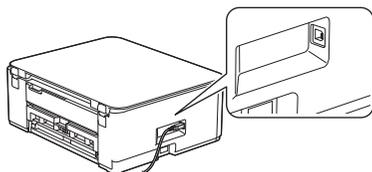
Per la connessione USB, reperire la porta corretta sul lato della macchina, come illustrato in figura.
