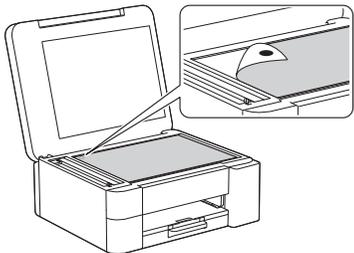
Posizionare la pagina di regolazione sul piano dello scanner con la facciata stampata rivolta verso il basso. Accertarsi che il cerchio nero sia posizionato in corrispondenza dell'angolo superiore sinistro del piano dello scanner, come illustrato in figura.
