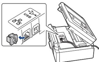
Per la connessione USB o la connessione di rete cablata (solo per alcuni modelli), reperire la porta corretta (a seconda del cavo utilizzato) all'interno della macchina, come illustrato in figura.
