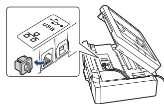
Pour une connexion USB ou une connexion par réseau câblé (sur certains modèles seulement), repérez le bon port (en fonction du câble que vous utilisez) dans l'appareil, comme illustré.
