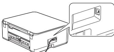
Pour utiliser une connexion USB, repérez le port approprié sur le côté de l'appareil, comme dans l'illustration.
