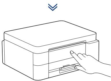
Sur l'écran ACL de l'appareil, sélectionnez les images qui correspondent le mieux à la façon dont chaque couleur apparaît sur la feuille de contrôle de la qualité d'impression, puis, si nécessaire, relancez la procédure de nettoyage.
