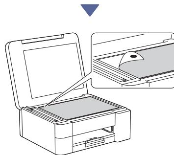
Placez la feuille d'ajustement face imprimée vers le bas sur la vitre du scanner en veillant à ce que le cercle noir se trouve dans le coin supérieur gauche de la vitre du scanner, comme dans l'illustration.
