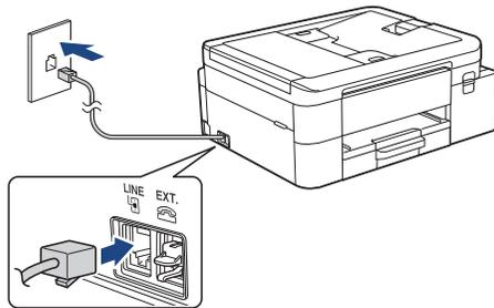
Introduzca el cable de la línea telefónica en la toma marcada como **LINE**.
