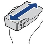
Agite rápidamente el cartucho **negro** en forma horizontal 15 veces, como se muestra, antes de insertarlo en el equipo.
