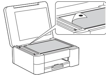
Coloque la hoja de ajuste boca abajo en el cristal del escáner y procure que el círculo negro quede en la esquina superior izquierda del cristal, como se ilustra.
