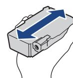
Agite rápidamente el cartucho **negro** en forma horizontal 15 veces, como se muestra, antes de insertarlo en el equipo.
