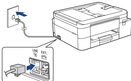
Introduzca el cable de la línea telefónica en la toma marcada como **LINE**.
