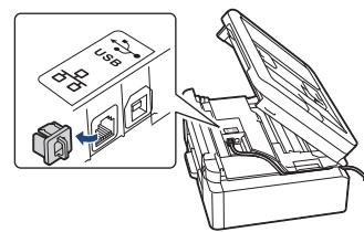
Para conectar el equipo con una conexión USB o una conexión de red cableada (solo ciertos modelos), busque el puerto correcto (según el cable que use) dentro del equipo, como se muestra en la imagen.
