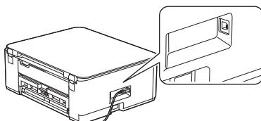
Para realizar una conexión USB, busque el puerto adecuado al costado del equipo, como se muestra en la imagen.
