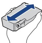
ブラックのインクカートリッジのみ、本製品に挿入する前に、図のように水平方向にすばやく15回振ってください。
