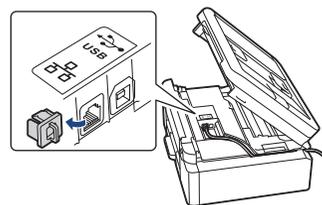
USB ケーブルまたは LAN ケーブル（特定のモデルのみ）を接続する場合、本製品内部の差し込み口は図の通りです。
