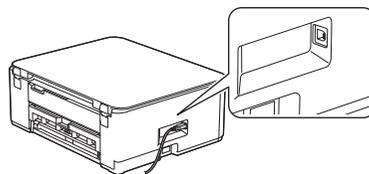
USB ケーブルを接続する場合、本製品側面の差し込み口は図の通りです。
