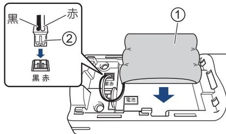
バッテリー①をセットして、バッテリーコードの黒 / 赤の方向が刻印に一致するように、コネクタ②を差し込みます。
