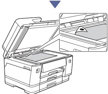
Legen Sie die Seite für die Druckanpassung mit der Vorderseite nach unten auf das Vorlagenglas und achten Sie darauf, dass sich der schwarze Kreis in der oberen linken Ecke des Vorlagenglases befindet (siehe Abbildung).
