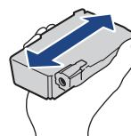
Schütteln Sie die **schwarze** Tintenpatrone horizontal 15 Mal wie angezeigt, bevor Sie sie in das Gerät einsetzen.
