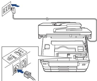
Stecken Sie das Telefonkabel in die mit **LINE** gekennzeichnete Buchse und führen Sie das Kabel auf der Rückseite des Geräts heraus.
