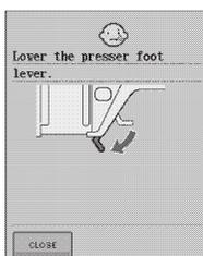
Essa mensagem será exibida quando o botão de "Levantador Calçador" for pressionado enquanto o calçador estiver levantado e/ou a agulha estiver abaixada.
