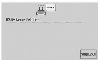
**Während der Datenübertragung wurde das USB-Kabel abgetrennt.**
