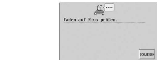
**Der Oberfaden wurde durchtrennt, oder der Faden ist aus dem Fadenspanner bzw. einer Fadenführung gerutscht. Der Faden ist nicht korrekt in die Maschine eingelegt.**
