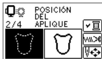
► Se cose la posición de la aplicación y la máquina de coser se detiene. "APLIQUE" aparecerá en la pantalla.
