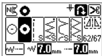
**3** Ajuste la longitud o el ancho de la puntada para seleccionar el tamaño de calado deseado.
