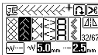
5 **Ajuste el ancho de la puntada en 7,0 mm (1/4 pulg.).**
