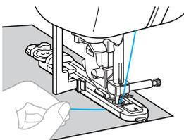
▶ Cuando termine la costura, la máquina coserá automáticamente puntadas de refuerzo y se detendrá.
