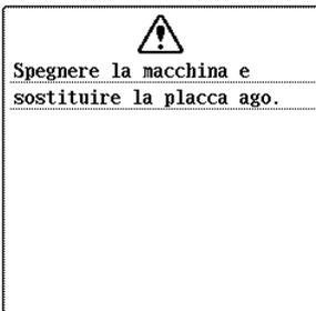
Questo messaggio viene visualizzato quando si tenta di cucire con un punto diverso da un punto con ago in posizione centrale mentre è installata la placca ago con foro singolo. Questo messaggio viene visualizzato quando la placca ago viene rimossa con la macchina accesa.
