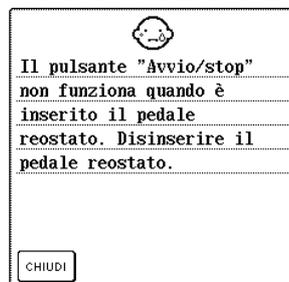
Questo messaggio viene visualizzato quando si preme il pulsante "Avvio/Stop" mentre il pedale reostato è collegato.
