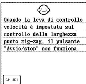
Questo messaggio viene visualizzato quando si preme il pulsante "Avvio/Stop" mentre il regolatore della velocità di cucitura è impostato per controllare la larghezza del punto zig-zag.
