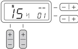
**3** Pulse el lado "+" de
