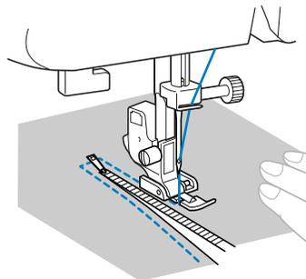
**5** Para coser el lado contrario de la cremallera, suelte el pie presionando el botón que se encuentra en la parte posterior del pie prensatela, coloque el pie para cremalleras al otro lado de la cremallera y continúe cosiendo utilizando la muesca del otro lado.
