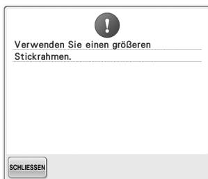
Die Meldung, dass der Stickrahmen gewechselt werden muss, wird möglicherweise auch dann angezeigt, wenn gar kein Stickrahmen installiert ist.
