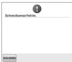
**Im Fadenabschneider kann sich Staub angesammelt haben. Reinigen Sie den Fadenabschneider. (Siehe Seite 246).**
