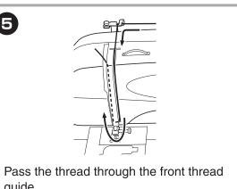
再把縫紉線繞過前方的導線板。
