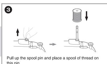
拉開線軸,把一軸縫紉線置入線軸上。
