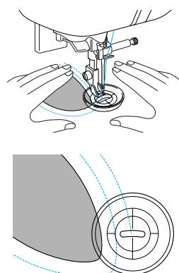
缝纫过程中，内部感应器会自动感应布料厚度，并且压脚抬起到设置画面中指定的高度。缝制弹性布料等特殊布料时，增加压脚抬起的高度以方便缝制。
