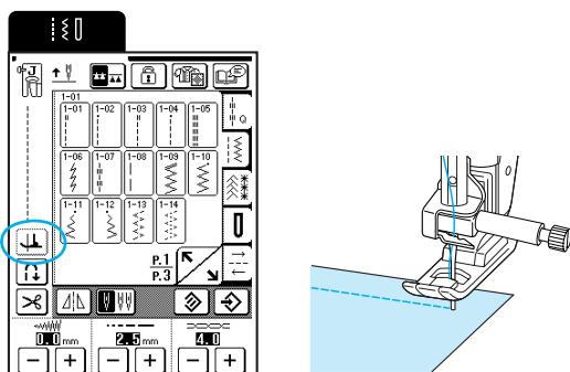
从设置画面可以将压脚调整到三种高度之一（3.2毫米、5.0毫米和7.5毫米）。
