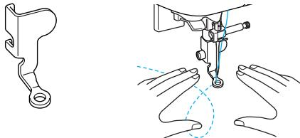
缝纫过程中，内部感应器会自动感应布料厚度，并且压脚抬起到设置画面中指定的高度。缝制弹性布料等特殊布料时，增加压脚抬起的高度以方便缝制。
