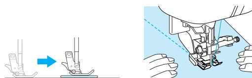
缝制时自动布料感应器系统连续运行。
