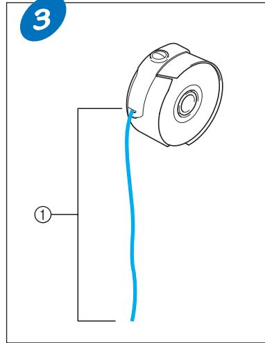
① 拉出约50毫米（2英寸）的线头。
