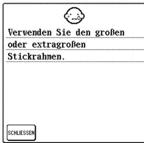
Diese Meldung erscheint, wenn im Stickmodus der mittlere Stickrahmen angebracht ist und das gewählte Muster größer als der Stickbereich des mittleren Stickrahmens ist.
