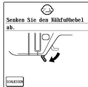
Diese Meldung erscheint, wenn bei angehobenem Nähfuß/ abgesenkter Nadel die Taste "Start/Stop", die Taste "Rückwärts/Vernähen" oder die Taste "Nähfußhebel" gedrückt wird.
