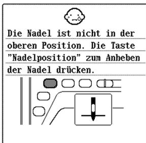
Diese Meldung erscheint, wenn die Maschine bei abgesenkter Nadel und eingesetzter Stickeinheit eingeschaltet wird.
