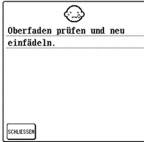
Diese Anzeige erscheint, wenn der Oberfaden gerissen oder nicht richtig eingefädelt ist, und die "Start/Stop"-Taste oder die "Verstärkungsstich"-Taste gedrückt werden.
