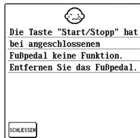
Diese Meldung erscheint, wenn die Taste "Start/Stop" bei angeschlossenem Fußpedal gedrückt wird.
