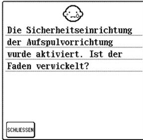
Diese Anzeige erscheint, wenn der Motor während des Aufspulens des Unterfadens blockiert, weil der Faden sich verwickelt hat etc.
