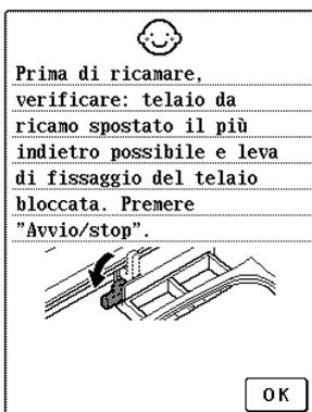
Viene visualizzato questo messaggio di conferma quando si accende la macchina e il carrello dell'unità da ricamo si è spostato in posizione iniziale.
