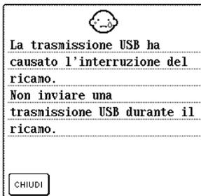
Se si scrivono o eliminano dati dal "Disco rimovibile" sul computer collegato durante la cucitura, la macchina si arresta e viene visualizzato questo messaggio. Al termine della trasmissione USB, premere il pulsante "Avvio/Stop" per continuare la cucitura.
