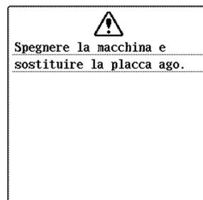
Questo messaggio viene visualizzato quando si tenta di cucire con un punto diverso da un punto con ago in posizione centrale mentre è installata la placca ago con foro singolo. Questo messaggio viene visualizzato quando si rimuove la placca ago mentre la macchina è accesa o quando è in funzione in modalità di ricamo o di modifica del ricamo.
