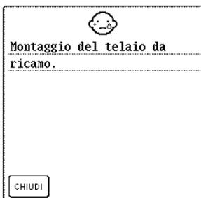
Questo messaggio viene visualizzato quando si preme il pulsante "Avvio/Stop" in modalità di ricamo ma il telaio da ricamo non è collegato.
