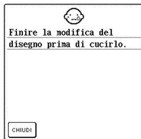
Questo messaggio viene visualizzato quando si preme il pulsante "Avvio/Stop" mentre si sta modificando un disegno in modalità di modifica del ricamo.
