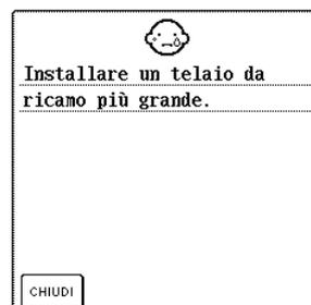
Questo messaggio viene visualizzato quando il disegno selezionato in modalità di ricamo è più grande dell'area di ricamo del telaio da ricamo piccolo mentre è collegato il telaio piccolo.
