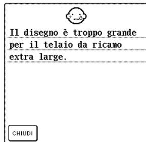
Questo messaggio viene visualizzato quando il disegno a caratteri combinati in modalità di ricamo è troppo grande per il telaio da ricamo.
