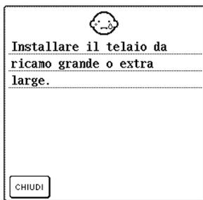
Questo messaggio viene visualizzato quando il disegno selezionato in modalità di ricamo è più grande dell'area di ricamo del telaio da ricamo medio mentre è collegato il telaio piccolo o medio.
