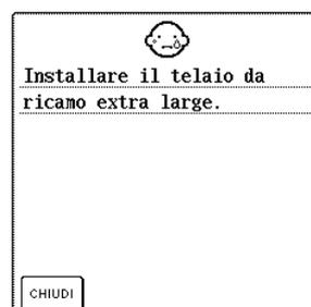
Questo messaggio viene visualizzato quando il disegno selezionato in modalità di ricamo è più grande dell'area di ricamo del telaio da ricamo grande mentre è collegato il telaio piccolo, medio o grande.
