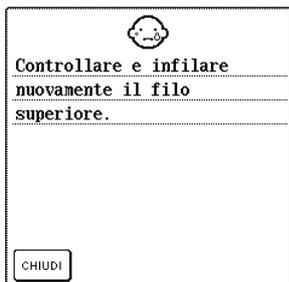
Questo messaggio viene visualizzato quando il filo superiore è rotto o non è infilato in modo corretto e si preme il pulsante "Avvio/Stop" o il pulsante "Punti di fermatura/rinforzo".
