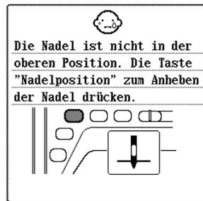
Diese Meldung erscheint, wenn die Nadel unten ist und der Nadeleinfädler abgesenkt wird.
