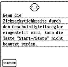
Diese Meldung erscheint, wenn die Taste „Start/Stopp“ gedrückt wird und der Nähgeschwindigkeitsregler zur Steuerung des Zickzackstiches eingestellt ist.
