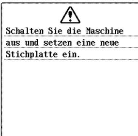
Diese Meldung erscheint, wenn Sie versuchen, mit einem Stich zu nähen, bei dem die Nadelposition nicht in der Mitte ist, während die Stichplatte mit nur einer Öffnung installiert ist.
