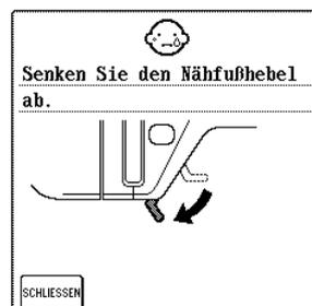
Diese Meldung erscheint, wenn bei angehobenem Nähfuß/ abgesenkter Nadel die Taste „Start/Stopp“, die Taste „Rückwärts/Vernähen“ oder die Taste „Nähfußhebel“ gedrückt wird.
