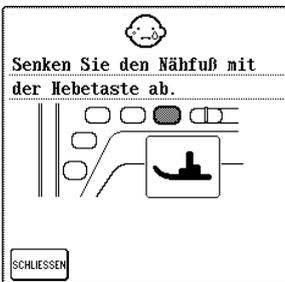
Diese Meldung erscheint, wenn bei angehobenem Nähfuß die Taste „Start/Stopp“, die Taste „Rückwärts/Vernähen“ oder die Taste „Fadenabschneider“ gedrückt wird.
