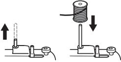
**2** Tout en maintenant le fil de la bobine de la main droite, faites passer le fil dans la rainure du guide-fil en le dirigeant vers vous. Ensuite, faites passer le fil autour du disque de pré-tension et introduisez complètement le fil.
