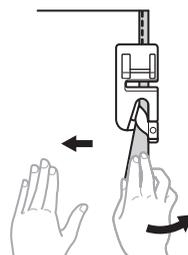
Tirez sur le tissu tenu de la main droite vers la droite afin de diminuer la quantité de tissu enroulée autour de la partie recourbée du pied-de-biche. En même temps, guidez soigneusement l'excédent de tissu vers la gauche à l'aide de votre main gauche.
