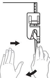
Tirez sur le tissu tenu de la main droite vers la gauche afin d'augmenter la quantité de tissu enroulée autour de la partie recourbée du pied-de-biche. En même temps, guidez soigneusement le tissu vers la droite à l'aide de votre main gauche.
