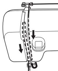
**7** Fare attenzione a guidare il filo attraverso la levetta del tendifilo da destra a sinistra come mostrato nell'illustrazione seguente.
