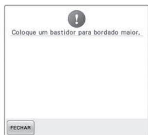
Uma mensagem indicando que o bastidor de bordar deverá ser trocado poderá surgir mesmo que não haja um bastidor instalado.
