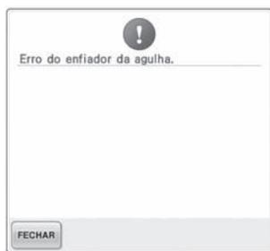
**O mecanismo automático de passagem da linha pela agulha não funcionou corretamente.**
