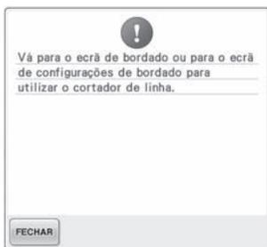
**O botão de cortar linha foi pressionado enquanto uma tela diferente da tela de execução do bordado ou tela de configurações do bordado estava sendo exibida.** Exiba a tela de execução do bordado ou a tela de configurações do bordado antes de utilizar a função de corte de linha.
