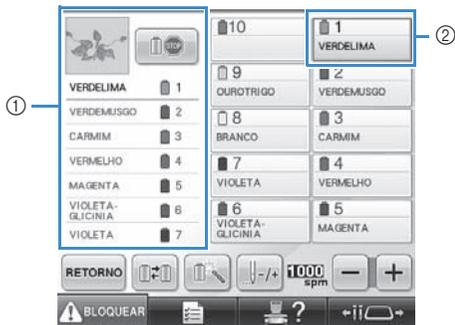
① A cor de linha da barra da agulha que está sendo utilizada ou que logo será utilizada para costurar é exibida no topo da seção de sequência de cores de linha. As cores de linhas restantes são listadas na ordem de costura, começando pelo topo.
