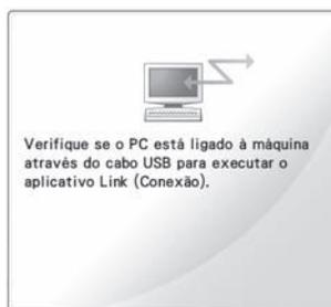
**A máquina falha ao comunicar-se com o PC no modo Link (Conexão).** Desligue a máquina e ligue-a novamente.
