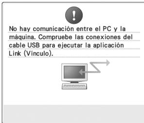
**La máquina no puede recibir datos del PC en el modo Link (Vínculo).** Apague la máquina y compruebe la conexión USB. Después de conectar el cable USB firmemente, vuelva a encender la máquina.
