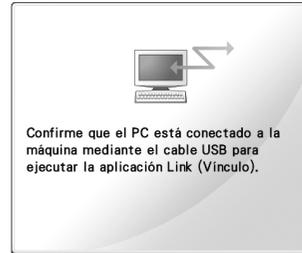
**La máquina no ha podido comunicarse con el PC en el modo Link (Vínculo).** Apague la máquina y, a continuación, vuelva a encenderla.
