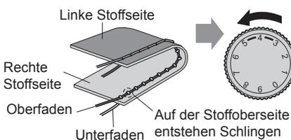
**Lösung:** Verringern Sie die Spannung, indem Sie die Oberfadenspannung auf einen niedrigeren Wert einstellen.
