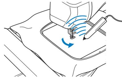
Quando si ricama, è possibile impostare la posizione del disegno rapidamente grazie alla funzione di posizionamento automatico mediante la penna sensore.
