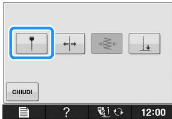
→ Viene visualizzata la schermata di impostazione della posizione dell'indicatore di guida e l'indicatore di guida lampeggia.
