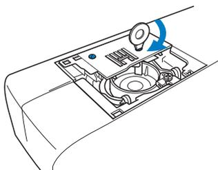
Ruotare il volantino per controllare che la griffa di trasporto si muova in modo uniforme e non tocchi i bordi delle fessure nella placca ago.
