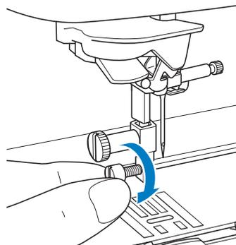
**6** Impostare la leva di funzionamento del piedino doppio trasporto in modo che la vite morsetto dell'ago sia posizionata tra le forcelle. Inserire il gambo del piedino doppio trasporto sull'adattatore montato sulla barra del piedino premistoffa.
