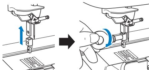
**5** Ruotare manualmente 2 o 3 volte una vite piccola fornita in dotazione.
