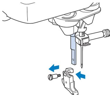
**4** Inserire l'adattatore nella barra del piedino premistoffa, allineando il lato piatto dell'apertura dell'adattatore al lato piatto della barra del piedino. Spingerlo verso l'alto il più possibile e serrare bene la vite con il cacciavite.
