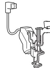
Il piedino per ricamo con puntatore LED fornito in dotazione indica la posizione dell'ago con un puntatore LED rosso.
