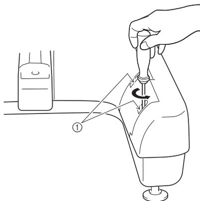
① Parafusos no braço da máquina
