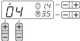
**2** Pulse el lado "+" o "-" de (tecla de ajuste de longitud de la puntada) para aumentar o reducir la longitud de la puntada.
