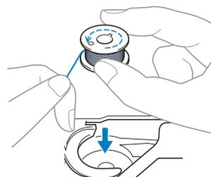
Si la bobina se inserta con el hilo desenrollándose en la dirección incorrecta, la costura se realizará con una tensión del hilo incorrecta.
