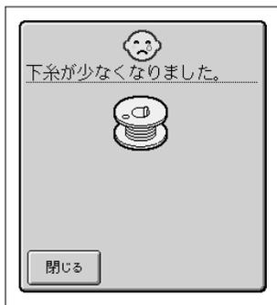
ぬっている途中で下糸が少なくなると、左のようなメッセージが表示されます。このとき、残りがわずかでも完成するようでしたら、そのままぬいつづけても構いません。まだ残っている場合は、ぬっている途中で下糸を交換する必要があります。メッセージが表示されたら以下の手順で下糸を交換してください。
