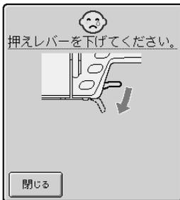
**2a** 押えレバーが上がった状態で、スタート/ストップスイッチ、返しぬいスイッチ、糸切りスイッチを押したときに表示します。
