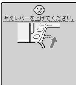
**2b** 押えレバーが下がっている状態で、刺しゅう機の初期設定をしようとしたときに表示します。
