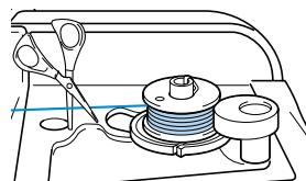
17 下糸巻き軸を左に戻し（①）、ボビンを軸から外します（②）。
