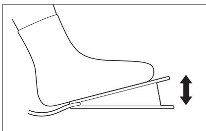
2. 電源スイッチを入れ、ぬう準備ができたならフットコントローラーをゆっくりと踏み込んでください。ミシンが動きます。本体のスピードコントロールレバーで設定された速度がフットコントローラーの最高速度になります。
