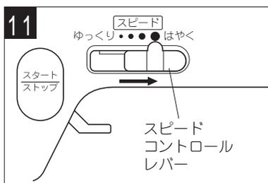
11 スピードコントロールレバーをスライドさせて、下糸巻きのスピードを決めてください。
