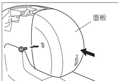
4. 面板を取り付け、ネジをドライバーでしっかりと締めてください。
