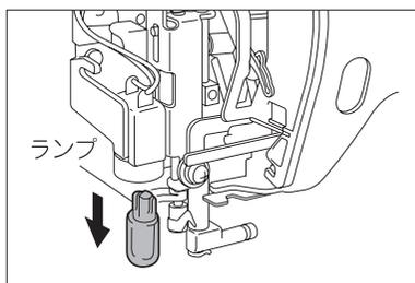
3. ランプを矢印の方向に引きぬいて外し、新しいランプを取り付けてください。
