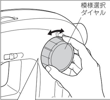
模様選択ダイヤルを回して、使用したい模様をフロントカバーの印に合わせてください。
