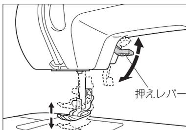
押えレバーを下げると押えが下がり、布地を押しえます。押えレバーは2段階に上がり、厚地の重ねぬいなど布地を入れにくいときは、レバーをさらに押し上げて入れます。(P.20参照)
