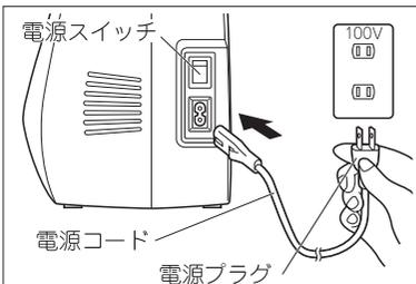
1. 付属のコードを本体右側面のコードジャックに差し込み、電源プラグをコンセントに差し込んでください。
