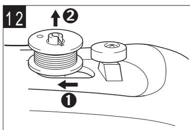
12 下糸巻き軸を左に戻し(①)、ボビンを外してください(②)。
