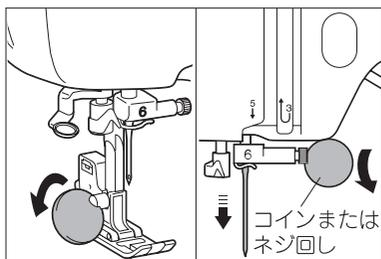
1. 電源スイッチを切り、電源プラグをコンセントから抜き、ネジをゆるめて押えホルダーと針を外してください。
