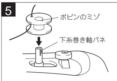
5 内側からポビンの穴に糸を通し、ポビンのミゾと下糸巻き軸バネの位置を合わせて軸の根元まで押し込んでください。
