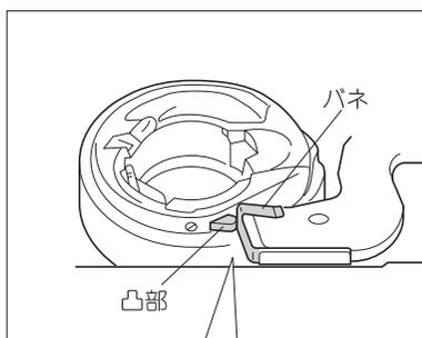
5. 内かまを外したときと同じ位置に外かま切欠部がきていることを確認し、内かまの凸部とパネを合わせて内かまを取り付けてください。
