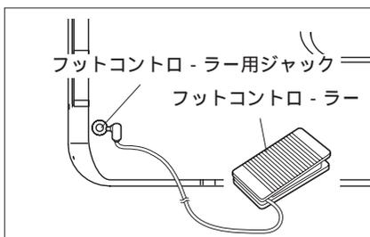
1. 電源スイッチを切って、フットコントローラーのプラグを本体裏面のジャックに差し込んでください。
