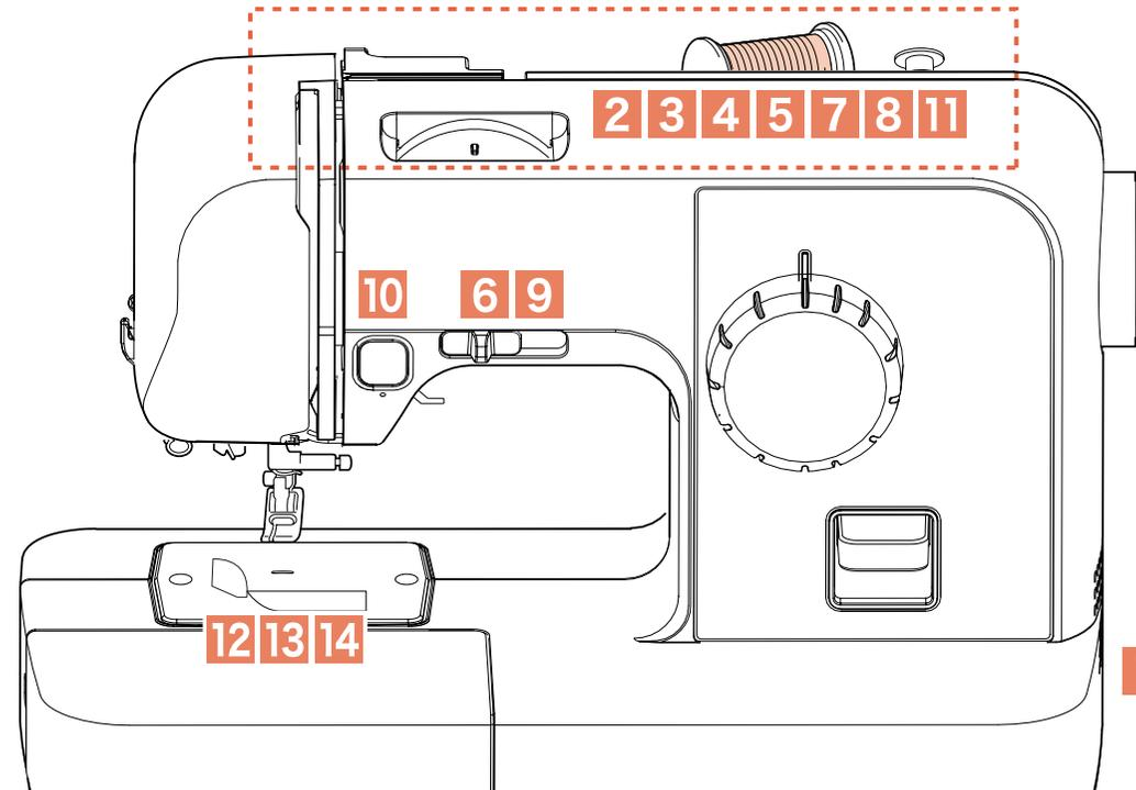
**5** ポビンのミゾと下糸巻き軸バネの位置を合わせて、ポビンを下糸巻き軸に差し込み、カチッと音がするまで矢印方向に押す
