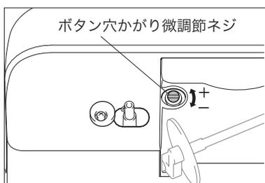
ボタン穴かがりの左右のぬい目長さは出荷時に調整してあります。使用される布と糸の組み合わせにより左右のぬい目長さが異なる場合がありますので、そのときはボタン穴かがり微調節ネジを回して調節してください。
