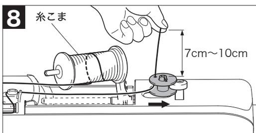
**8** 糸を7cm～10cm引き出し、糸端を持ってスタート/ストップスイッチを押し、ボビンを10回程度回転させます。
