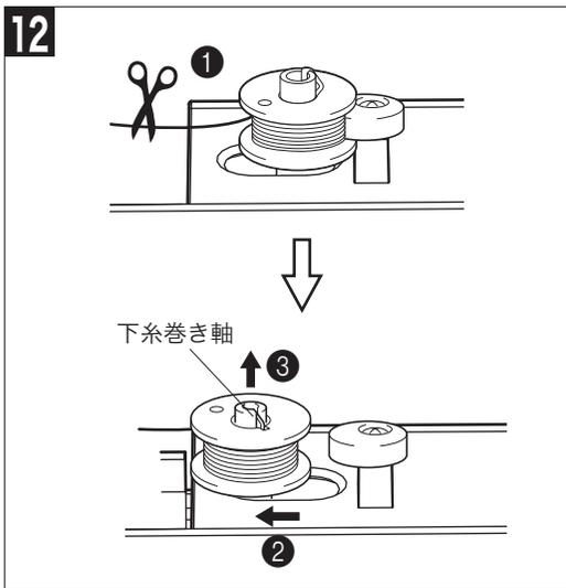
**12** はさみで糸を切り (①)、下糸巻き軸を左に戻し (②)、ボビンを軸から外します (③)。スピードコントロールレバーを「ゆっくり」の方に戻します。
