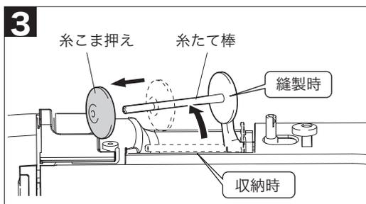
**3** 糸たて棒を後側に倒して、糸こま押えを外します。
