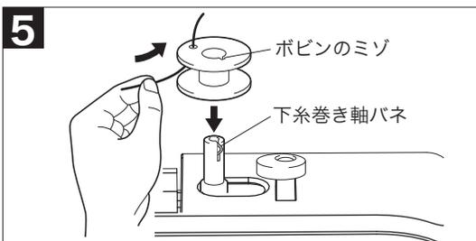
**5** 内側からポビンの穴に糸を通し、ポビンのミゾと下糸巻き軸バネの位置を合わせて軸の根元まで押し込みます。
