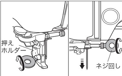
1 電源スイッチを「切」にし、電源プラグをコンセントから抜いて、押えを外します。(P.17「押えを交換する」参照)
