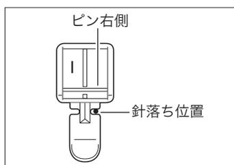
6 片押え<1>のピンの右側を押えホルダーに取り付けます。（P.17「押えを交換する」参照）
