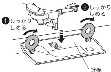
**15** 押えホルダーを取り付け、ネジを確実にしめます。
