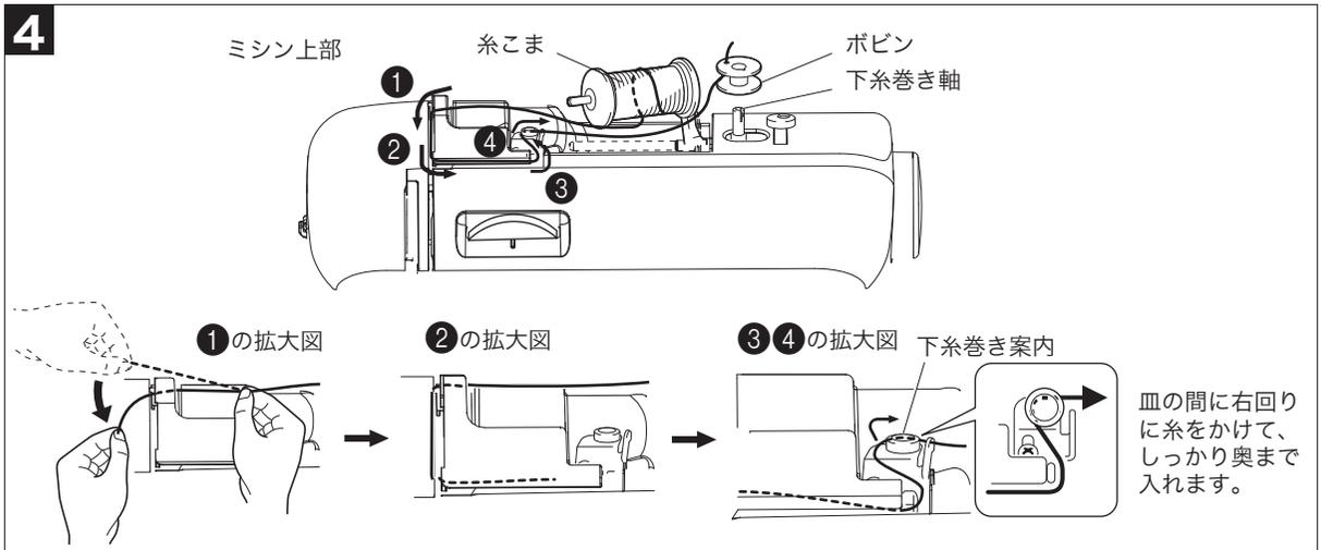
**4** 糸こま部の糸を右手で保持しながら左手で糸端を持ち、下糸巻き案内表示 (破線) に従い、①～④の順番でミゾにそって順序よく糸を通してください。
