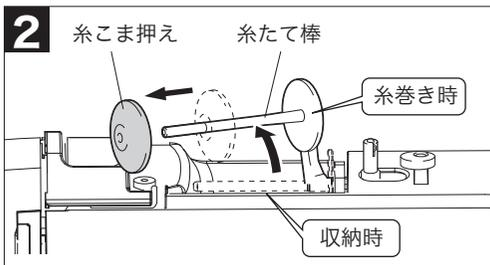
2 糸たて棒を後側に倒して、糸こま押えを外します。
