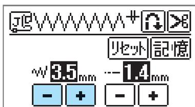
振り幅の
