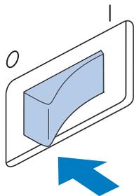
▶ 電源が切れ、液晶画面とスタート/ストップスイッチの点灯が消えます。
