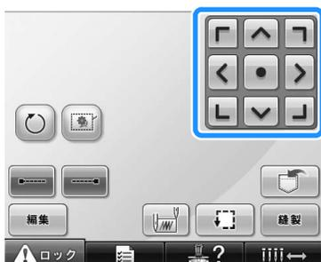
▶ 矢印の方向に模様表示エリア模様が移動します。
