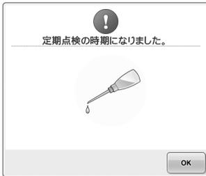
このメッセージが表示されたら、ミシンを正規販売店かお近くの正規サービスセンターに持ち込み、定期メンテナンスチェックを受けることをおすすめします。を押すと、このメッセージは消え、ミシンを使い続けることができますが、適切なメンテナンスが実行されるまで、このメッセージは繰り返し表示されます。適切なメンテナンスで、継続して快適にミシンをご使用いただけるようになります。
