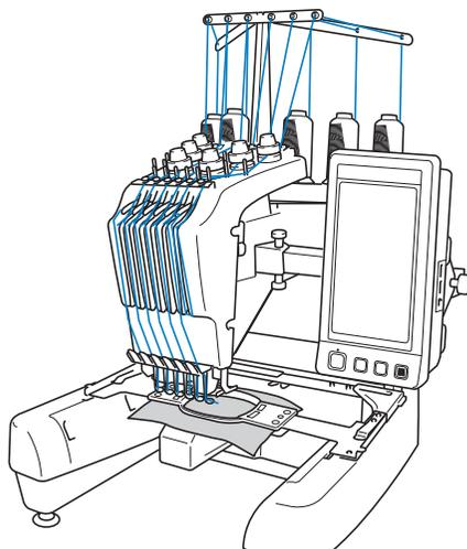
縫製は、6本の針で同時にぬうのではなく、縫製位置にある1本の針でぬいます。ぬい順に従い、針棒ケースが左右に動いてその色がかけられた針棒・針が縫製位置に移動します。
