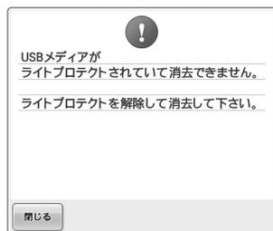
**USBメディアがライトプロテクトされている状態で、模様を消去しようとした**ライトプロテクトを解除して消去してください。
