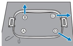
まず、① 調節ネジのある角を合わせ、内枠を押し込みます。次に、② の矢印の方向に布地を軽く引っ張りながらたるみが出ないようにして、③ の角に押し込みます。同様に、④ の矢印の方向に引っ張りながら ④ の角に、① の矢印の方向に引っ張りながら ① の角に押し込みます。
