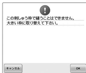
今回使用するネーム枠より、実際にネームデータが大きと思われる場合は、いったん **キャンセル** を押して大きさや位置を変えたデータを送信し直してください。現時点で設定されているネーム枠ではなく、より大きなネーム枠を使用する場合は、**OK** を押して、手順 12、13 と進み、模様の大きさに合ったネーム枠を選択してください。また、必ず選択した枠と同じ枠をミシンに取り付けてください。
