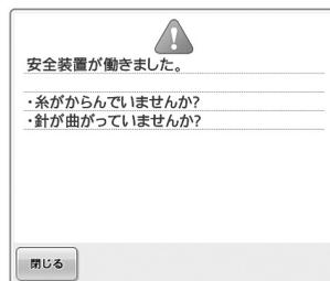
**糸がからむ、針が曲がるなどの異常が発生した**ミシンが異常を検知して止まりました。糸が正しくかかっているか（P.61参照）、針が曲がっていないかを確認してください。
