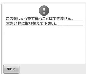
刺しゅう枠をセットしていない状態でも、枠の交換が指示されることがあります。ミシンは、台枠の左アームの位置でどの枠がセットされているか感知します。したがって、実際に刺しゅう枠がセットされていない状態でも、左アームの位置で判断します。また、台枠がセットされていない状態では、帽子枠(別売)がセットされていると判断します。
