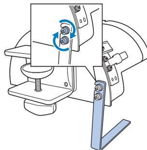
ゲージを机のような安定した取付面に付けます。
