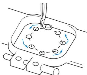
刺しゅう枠の動きをよく見て、刺しゅうしたい場所とずれていないか、刺しゅう枠と重なっていないか、確認してください。
