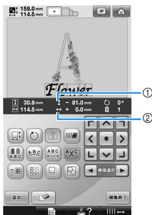
① 移動したときの縦の移動距離を示します。
