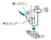
5 取り付ける押えのピンの部分と押え ホルダーのミゾが合う位置に押えを 置きます。
