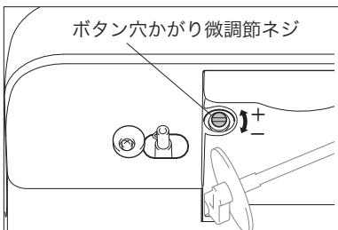
ボタン穴かがりの左右のぬい目長さは出荷時に調整しています。使用される布と糸の組み合わせにより左右のぬい目長さが異なる場合がありますので、そのときはボタン穴かがり微調節ねじを回して調節してください。
