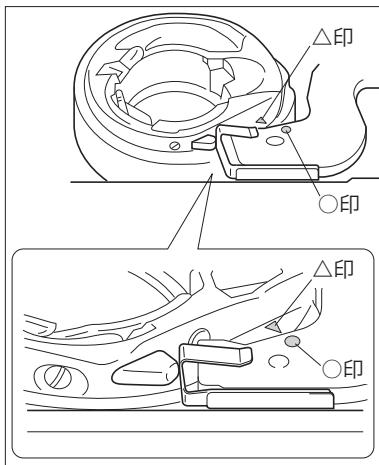
**6** 左図のように、△印と○印を合わせて内かまを取り付けます。
