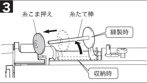
**3** 糸たて棒を後側に倒して、糸こま抑えを外します。
