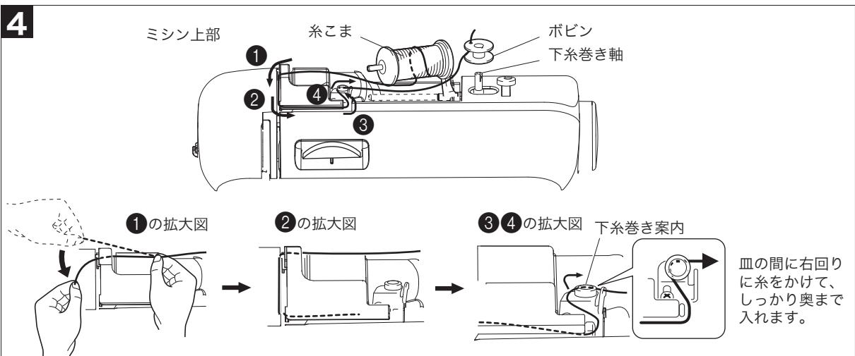
**4** 糸こま部の糸を右手で保持しながら左手で糸端を持ち、下糸巻き案内表示（破線）に従い、①～④の順番でミゾにそって順序よく糸を通してください。
