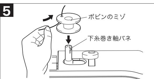
**5** 内側からボビンの穴に糸を通し、ボビンのミゾと下糸巻き軸バネの位置を合わせて軸の根元まで押し込みます。
