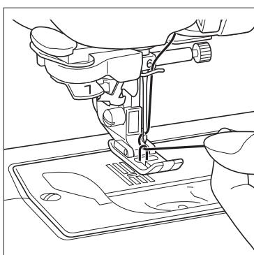
**3** 上糸を引き上げると、下糸が針板の穴から輪になって出てきます。
