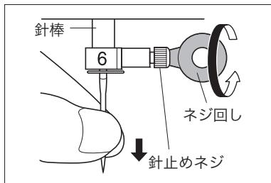
1 電源スイッチを「切」にし、針を上げ、押えレバーを下げます。
