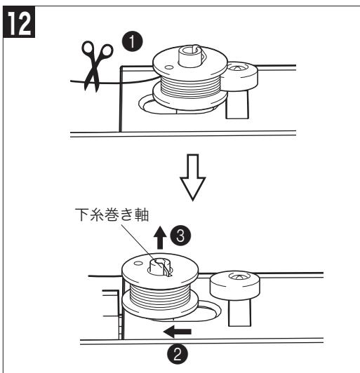
**12** はさみで糸を切り(1)、下糸巻き軸を左に戻し(2)、ボビンを軸から外します(3)。スピードコントロールレバーを「ゆっくり」の方に戻します。
