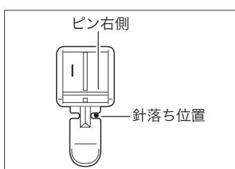
6 片押え<I>のピンの右側を取り付けます。（P.17「押えを交換する」参照）
