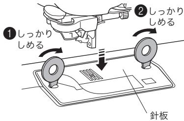
**15** 押えホルダーを取り付け、ネジを確実にしめます。
