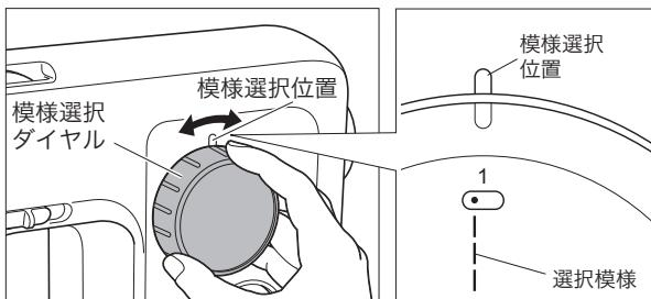
模様選択ダイヤルを回して、ダイヤル上の使用したい模様を、模様選択位置に合わせます。
