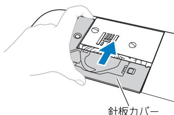
11 付属のネジ回しで針板カバーのネジを締めます。
