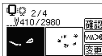
針数が表示されていないときは、設定 (設定キー) を押して表示を切り替えます。戻る (戻るキー) を押すと、もとの画面に戻ります。
