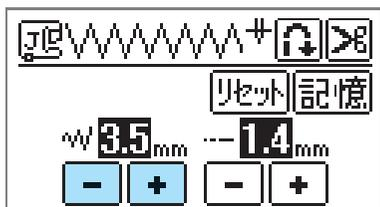
振り幅の
