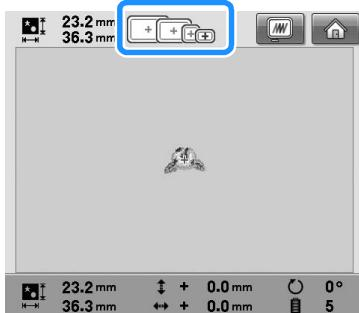
使用できる刺しゅう枠は濃く（）、使用できない刺しゅう枠はグレー（）で表示されます。
