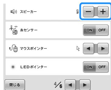
▶ キーを押して操作音を鳴らし、希望の音量が選択されていることを確認してください。
