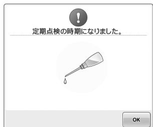
このメッセージが表示されたら、ミシンを正規販売店かお近くの正規サービスセンターに持ち込み、定期メンテナンスチェックを受けることをおすすめします。[OK]を押すと、このメッセージは消え、ミシンを使い続けることができますが、適切なメンテナンスが実行されるまで、このメッセージは繰り返し表示されます。適切なメンテナンスで、継続して快適にミシンをご使用いただけるようになります。
