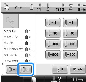
▶ 1回押すごとに1色ずつ次の色へ、色替表示がスクロールします。最後の色が色替表示の1番上にきた後は、最初の色に戻ります。
