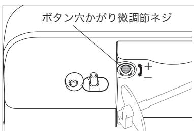
ボタン穴かがりの左右のぬい目長さは出荷時に調整されています。使用される布と糸の組み合わせにより左右のぬい目長さが異なる場合がありますので、そのときはボタン穴かがり微調節ネジを回して調節してください。
