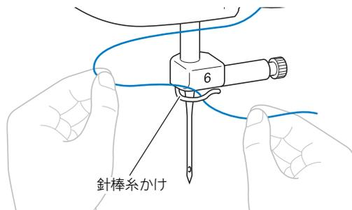
**10** 「上糸を通す」の⑭～⑮ (→P.25) に従って、糸通し装置で針に糸を通します。
