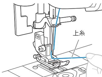
**5** 針が上がっている状態で、④(針上下スイッチ)を2回押します。
