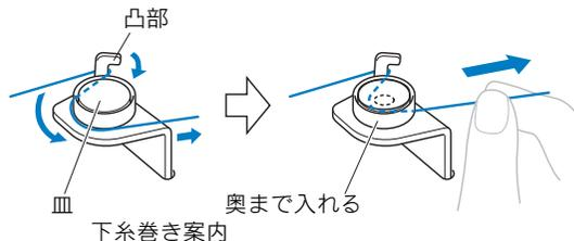
**9** 下糸巻き案内にかけた糸を左手で押さえ、引き出した糸を右手でポビンに時計回りに5～6回巻き付けます。
