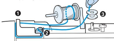
4. ボビンのミゾと下糸巻き軸バネの位置を合わせて差し込み、
