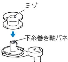
3 軸にセットしたポビンをカチッと音がするまで右側に押します。
