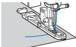
⑥ ポケット口が手前になる向きでポケット口より 2mm 手前に針が刺さる位置に布地を置き、押えを下げます。
