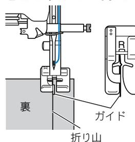
**6** ジグザグの振り幅調節キーの「-」を押して、針が折り山に少しかかる位置に調節してガイドに合わせながらぬきます。
