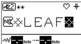
→ Die Reihenfolge, in der die Muster im Bildschirm angezeigt werden, ist die Nähreihenfolge.
