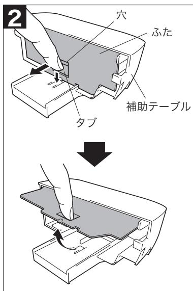
2 補助テーブルのふたの穴に指を入れて、タブを下に押し付けながら手前に引きます。
