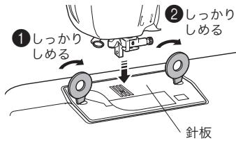
**15** 押えホルダーを取り付け、ネジを確実にしめます。
