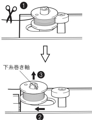
**12** はさみで糸を切り(①)、下糸巻き軸を左に戻し(②)、ボビンを軸から外します(③)。スピードコントロールレバーを「ゆっくり」の方に戻します。
