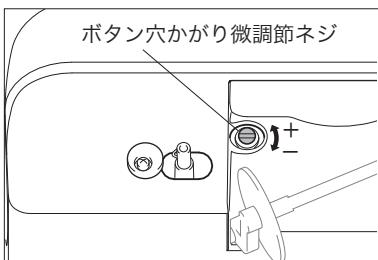
ボタン穴かがりの左右のぬい目長さは出荷時に調整されています。使用される布と糸の組み合わせにより左右のぬい目長さが異なる場合がありますので、そのときはボタン穴かがり微調節ネジを回して調節してください。
