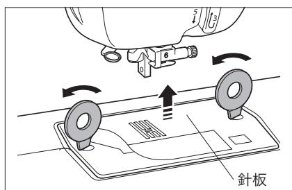
3 ネジを外して針板を取り外します。
