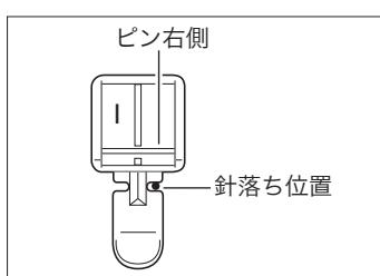
6 片押え<I>（別売）のピンの右側を取り付けます。（P.17「押さえを交換する」参照）
