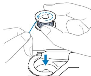
如果放入梭子後，線從錯誤的方向繞出，則縫紉時線張力將不正確。
