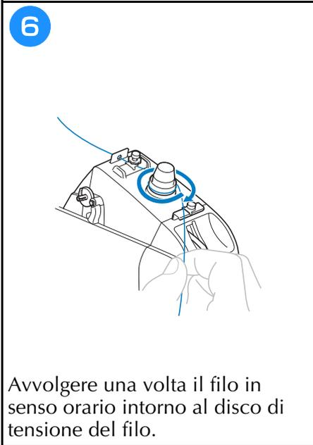
Avvolgere una volta il filo in senso orario intorno al disco di tensione del filo.
