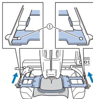
Inserire il telaio per ricamo, finché non scatta in posizione.
