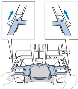
Far scorrere il telaio per ricamo nel fermaglio sul supporto del telaio per ricamo. Il telaio interno deve trovarsi sopra.
