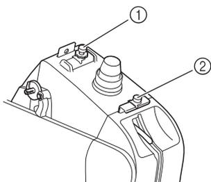
Pulire le placche guidafilo sia del guidafilo superiore ① che del guidafilo centrale ②.
